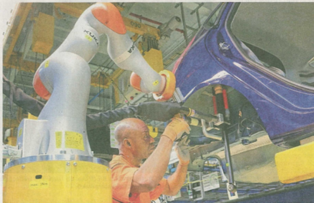
Zusammenarbeit von Mensch und Maschine in der Ford-Fertigung in Köln: Ausgestattet mit Schrauben und Stoßdämpfer fährt der Leichtbauroboter automatisch in Richtung des Radhauses der Fahrzeug-Karosserie. Dort kontrolliert der Mitarbeiter noch einmal die Position und gibt das Signal zum Schrauben. FOTO: FRIEDRICH STARK/065/FORD-WERKE GMBH
